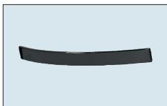
N° 727 Poignée arc métallique aspect chrome noir Entraxe perforations : 160 mm Saillie vers l'avant : 25 mm
